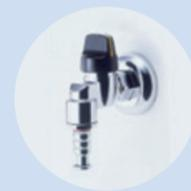
ヒューズガス栓には、万が一ゴム管がはずれて規定以上のガスが流れると自動的にガスをとめる安全装置がついています。
